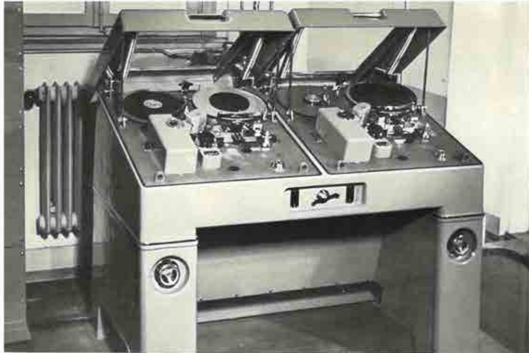
Studio de Berne: Appareil Philips-Miller pour l'enregistrement et la reproduction sur film
